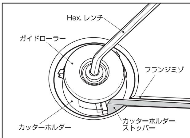
1. カッターホルダーストッパーをフランジミゾにはめ込み、カッターホルダーがまわらないように固定し、ガイドローラーをHex. レンチで外し、カッター刃全体を露出させてください。
