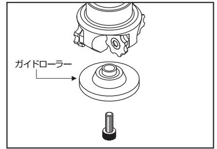
3. ガイドローラーを抜き取って交換して下さい。
