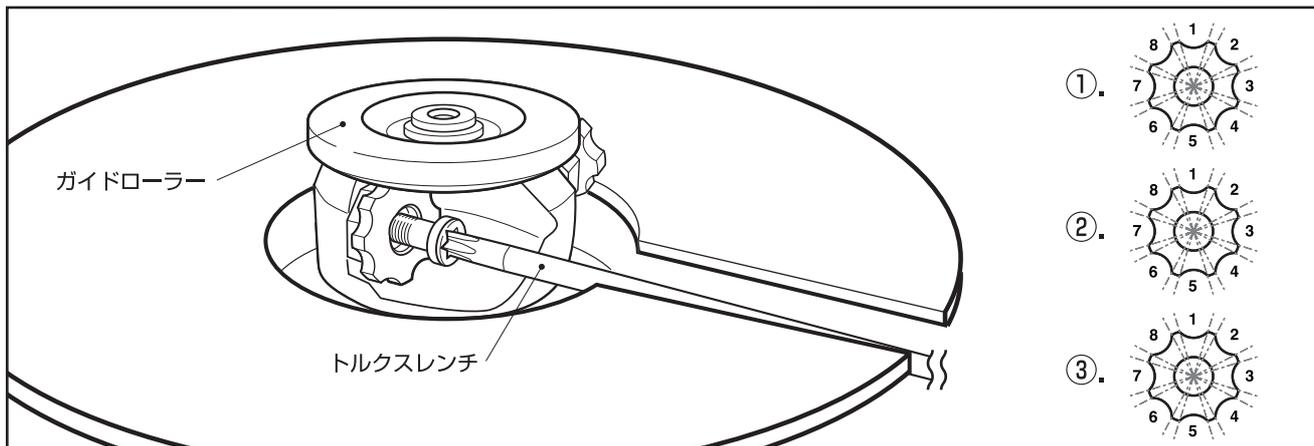
1. トルクスレンチでカッター刃のネジを緩め、3個の刃 (①・②・③) の角度を合わせてください。
