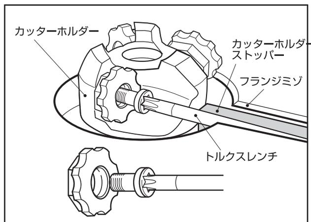
2. トルクスレンチでカッター刃のネジを外して、それぞれの刃を取り出し、交換してください。
