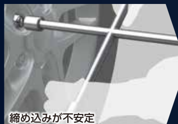
締め込みが不安定
